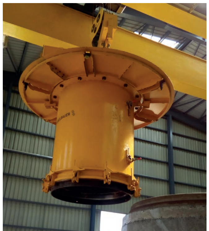
При помощи цехового крана свежееотформованные трубы доставляются в зону выдержки
