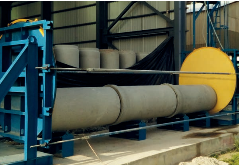
Испытания произведенных на установках Exact XL и Precise бетонных труб на герметичность и стойкость к давлению
