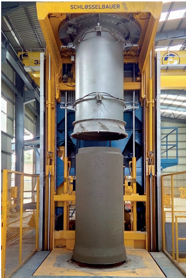
Производство раструбной бетонной трубы диаметром DN800 на установке Precise компании Schlüsselbauer Technology
