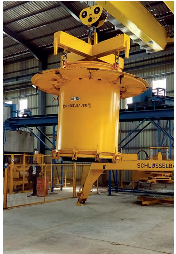
Подача оснащенной стальной формы на производственную установку Exact XL
