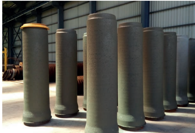
Выдержка распалубленных изделий на заводе Trans-Canal Centre занимает один рабочий день
